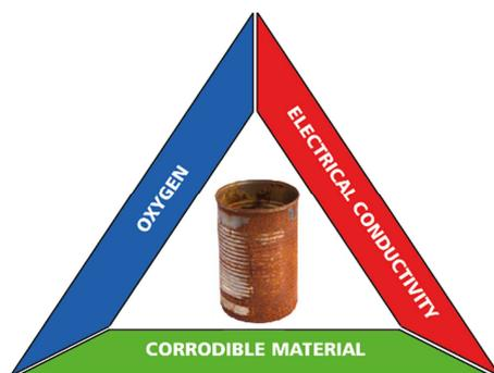
Figura 4a. El Triángulo de la Corrosión
